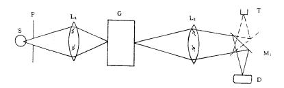
图 1 二位转镜直接比较法
