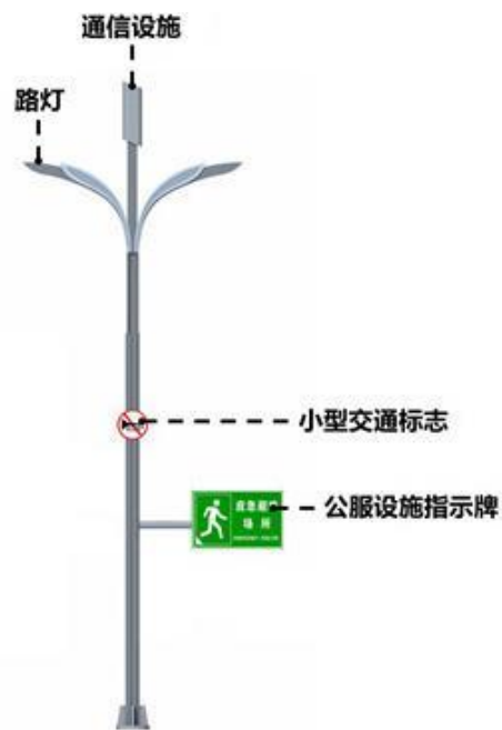
图 6 F 类杆典型杆件样式示意图
