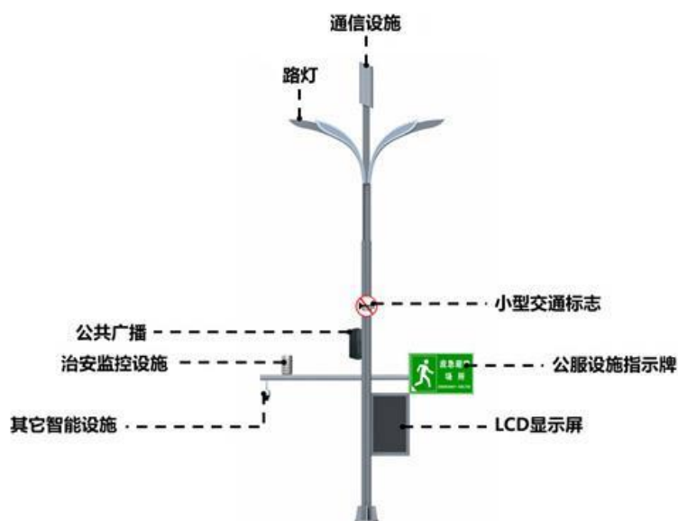
图 5 E 类杆典型杆件样式示意图
