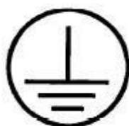
图 13 保护接地图形符号
